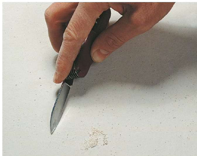
Bild 77: Prüfung des Kornaufbaus
