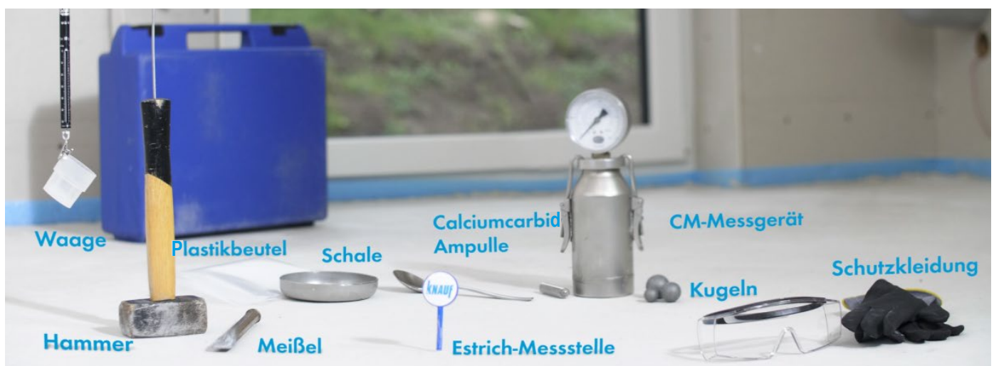
Bild 74: Prüfen auf Belegreife mit dem CM-Gerät
