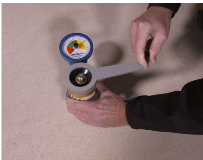
Bild 79: Prüfung auf Haftzugfestigkeit
