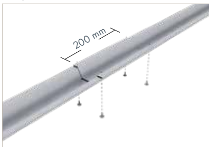
Monteringsprofilerne kan samles med flyverstød med en overlapning på min. 200 mm. Samles med 4 stk. skrue R/R 13.
